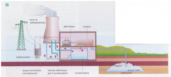
Nelle centrali geotermoelettriche si utilizza il vapore surriscaldato che si forma nel sottosuolo quando una massa d'acqua viene in contatto con rocce incandescenti. Il vapore proveniente dal sottosuolo viene trasformato in energia.
