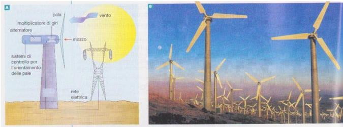
Le centrali eoliche fruttano l'energia del vento. La parte più importante di una centrale eolica è l' "aerogeneratore", che è un dispositivo a una o più pale che vengono messe in azione dal vento. Il movimento delle pale viene trasformato in energia elettrica.
