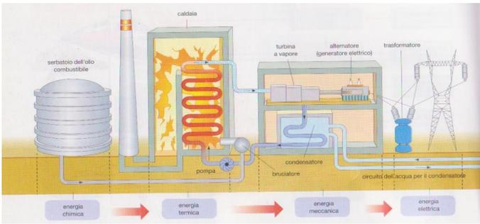
Gran parte dell'energia che utilizziamo viene prodotta in impianti chiamati "centrali termoelettriche" dove si sfrutta l'energia termica sviluppata dalla combustione del carbone, del petrolio e del metano.
