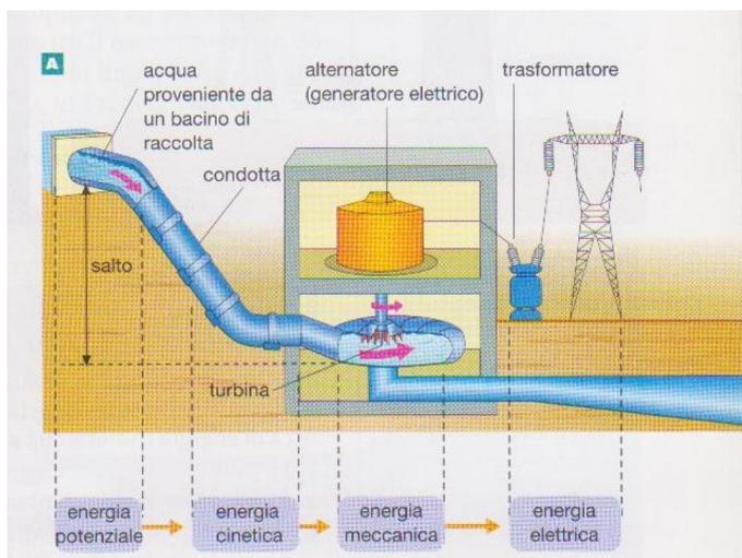
Una massa d'acqua contenuta in un bacino di raccolta, situato ad una certa quota, viene immessa in una tubazione, chiamata "condotta forzata", che la conduce alla centrale.
